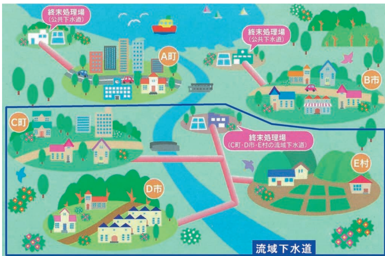
図Ⅲ－1 流域下水道の概要図
