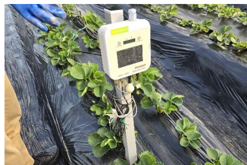
イチゴほ場に設置した環境測定機器
