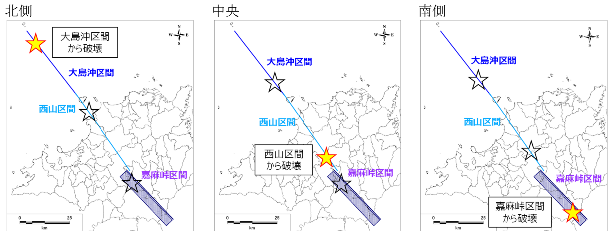
図Ⅱ.2-8 西山断層帯全区間連動の破壊開始点(北側・中央・南側)の概略図
