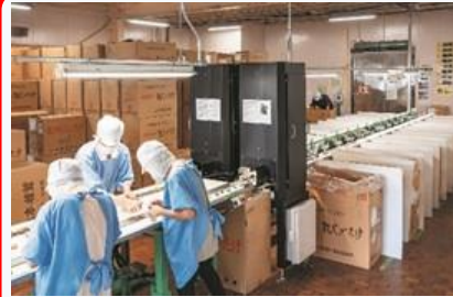
中央の黒い画像処理装置(AI) により30種を自動選別
