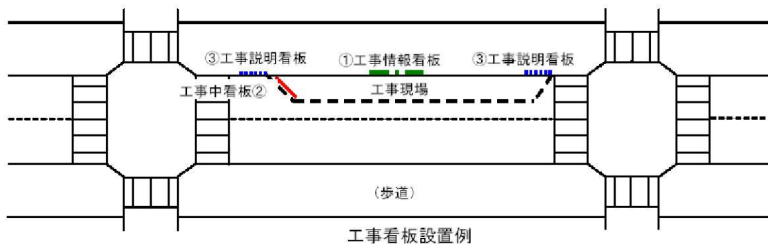
標示板の設置場所
