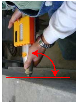
写真左 反発度の測定状況 上下方向の角度に注意！
