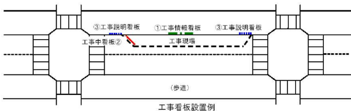
標示板の設置場所
