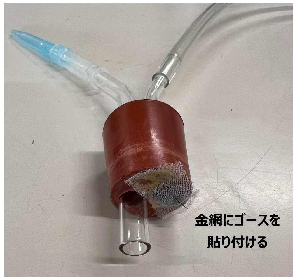
吸虫管本体と取り付け品（左図）、吸虫管本体の底面（右図）
