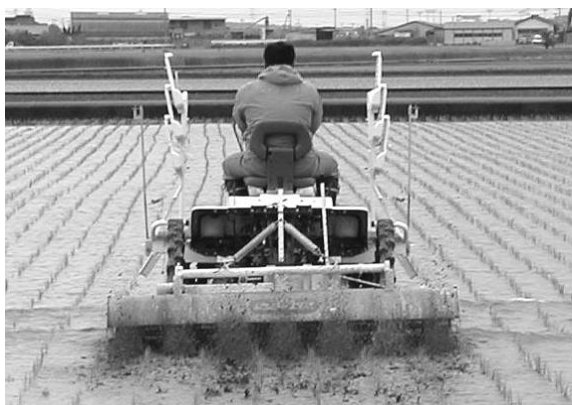
高精度水田用除草機による除草作業
