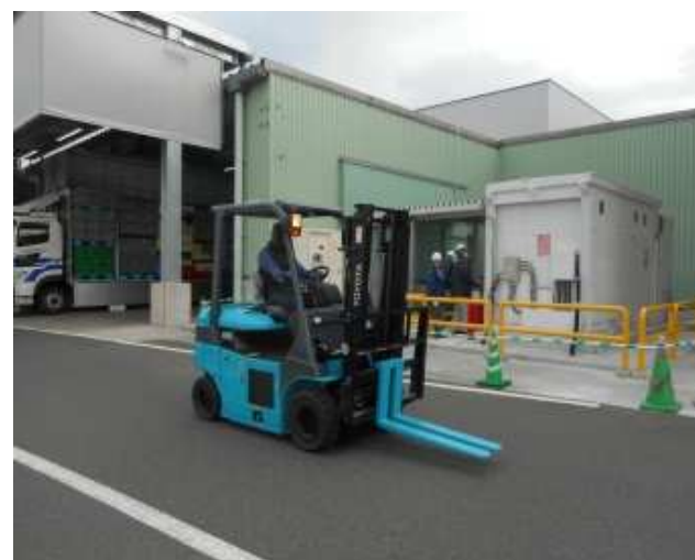
工場内の燃料電池フォークリフト
