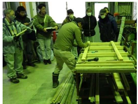
竹製残存型枠の加工組立の実演
