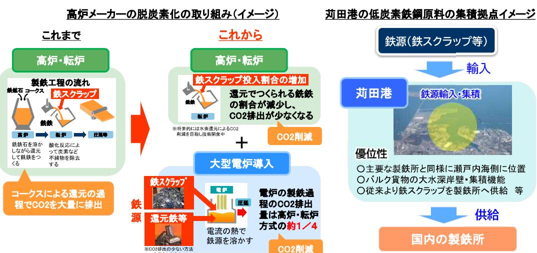
図 6.19 低炭素鉄鋼原料の取扱拠点の形成イメージ
