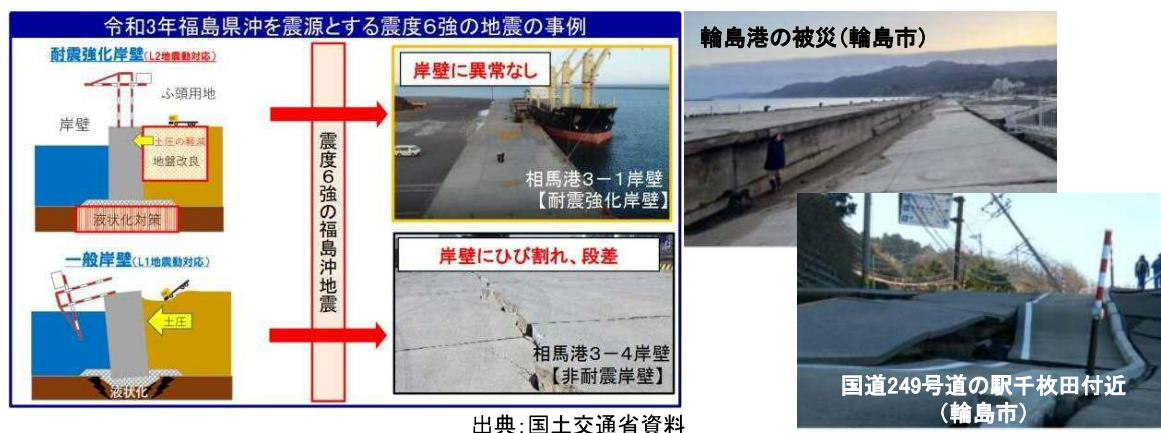
図 6.35 耐震強化岸壁の整備効果と岸壁の地震被災事例 (R6 能登半島地震)
