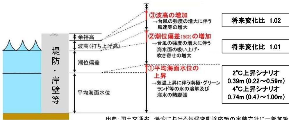
図 6.37 気候変動に伴う外力の変化
