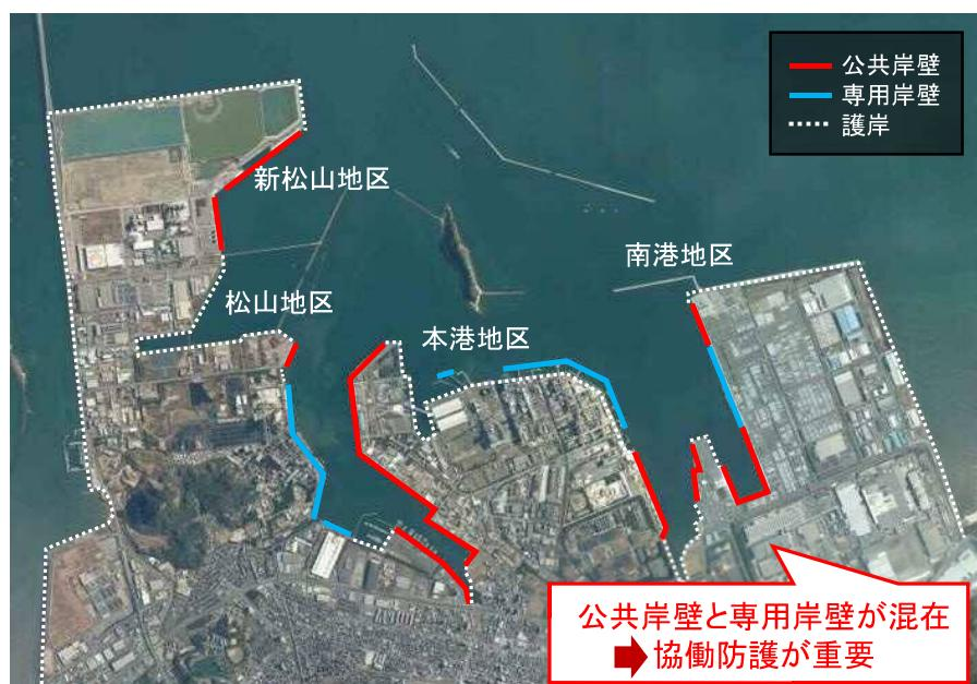
図 6.39 苅田港における公共岸壁と専用岸壁の配置
