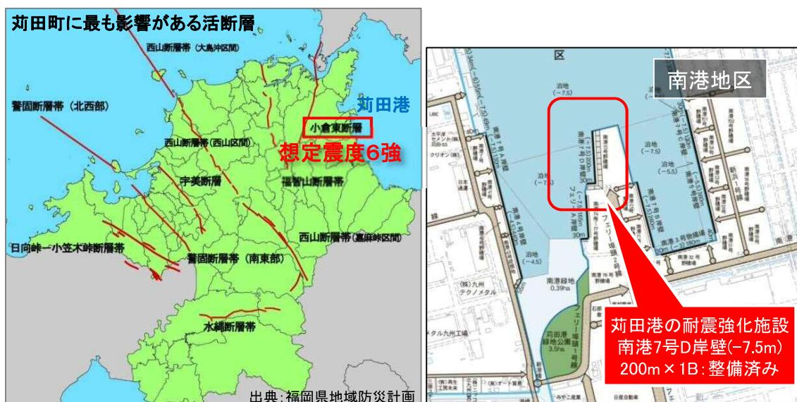
図 5.15 苅田港の想定地震（小倉東断層）と耐震強化岸壁
