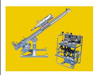
エアーキッド AK-01 の仕様 項目 仕 様·形 状 削孔角度 任意 *ф*66mm 削孔呼径 二重管式 φ106mm(最小内径 φ67mm) 給進ストローク 1400mm 回転数 0~30rpm 回 転トルク 1.23kN·m(max) 給進力 7.84kN(max) 引抜力 7.84kN(max) 供給エア量 10~15m³/min×1~1.5MPa 4 (L)2190 × (W)660 × (H)980mm 分解質量 max.65kg 総質量 本体 230kg、操作スタント 65kg
