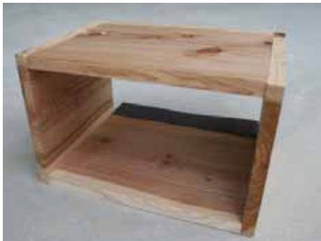
土砂受け箱 (写真3)
