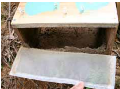
土砂受け箱に貯まった土砂
