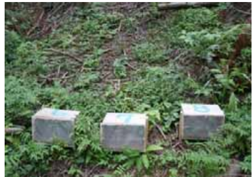
土砂受け箱の設置状況
