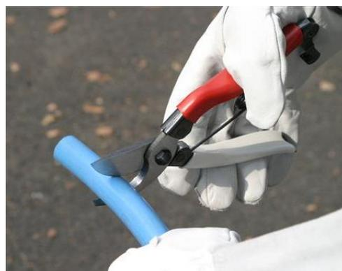
写真4 水道用ホースを果樹用剪定バサミで切る
