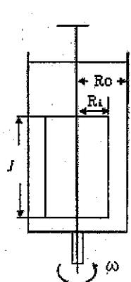
図2 共軸二重円筒形回転粘度計
