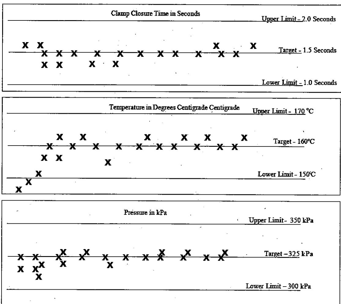
この分析から温度上下限の中で、温度が最も変動していることが分かる。初めの15分から20分にかけての温度は、シータの要求事項の限界よりも低かった。このスクリーニング試験の結果はシールの完全性の基本的な因子である可能性を示している。
