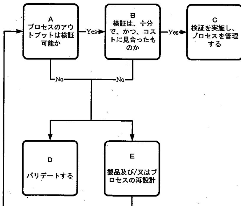
図1 プロセスバリデーション デシジョンツリー
