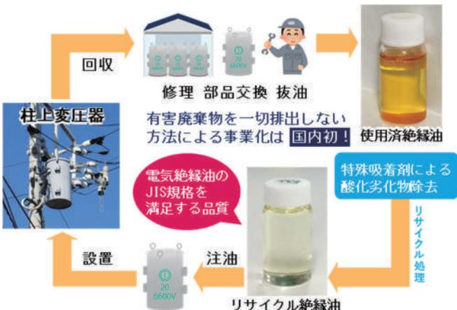
柱上変圧器使用済絶縁油のリサイクル処理
