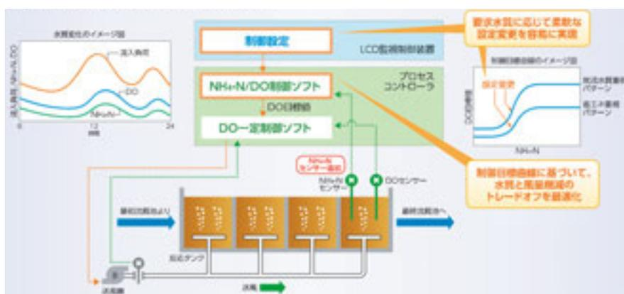
図Ⅲ-24 NH<sub>4</sub>-Nセンサーを活用した曝気風量制御技術の概要
