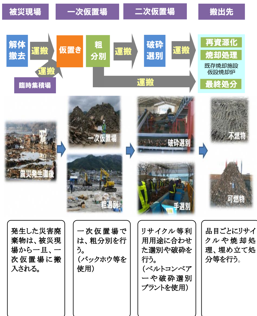
図表 52 仮置場への搬入、仮置場からの搬出の流れ
