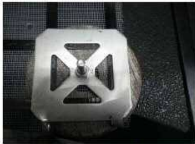
写真5 ワッシャー固定部
