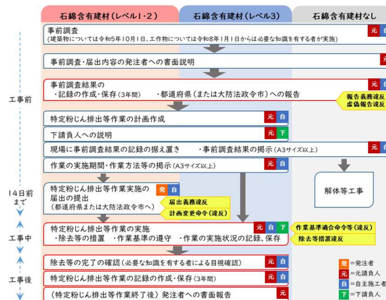
建築物・工作物の解体等工事の流れ(大気汚染防止法 関連)
