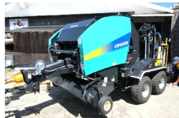
▲生産効率を改善する機械 〔牧草をロール状に圧縮し、フィルムでラッピング〕
