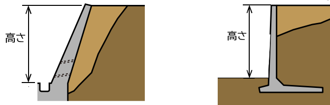
図1-3 許可対象となる擁壁の高さイメージ図
