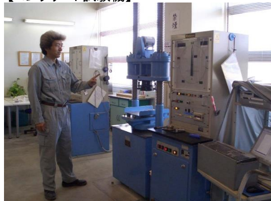
【コンクリート試験機】
