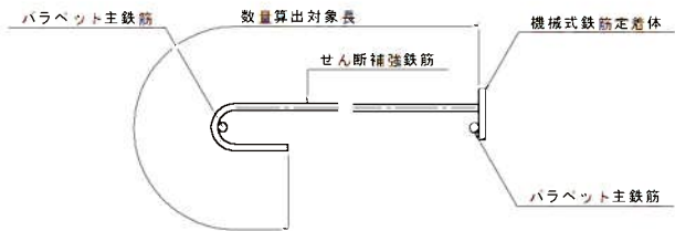
機械式鉄筋定着工法参考図
