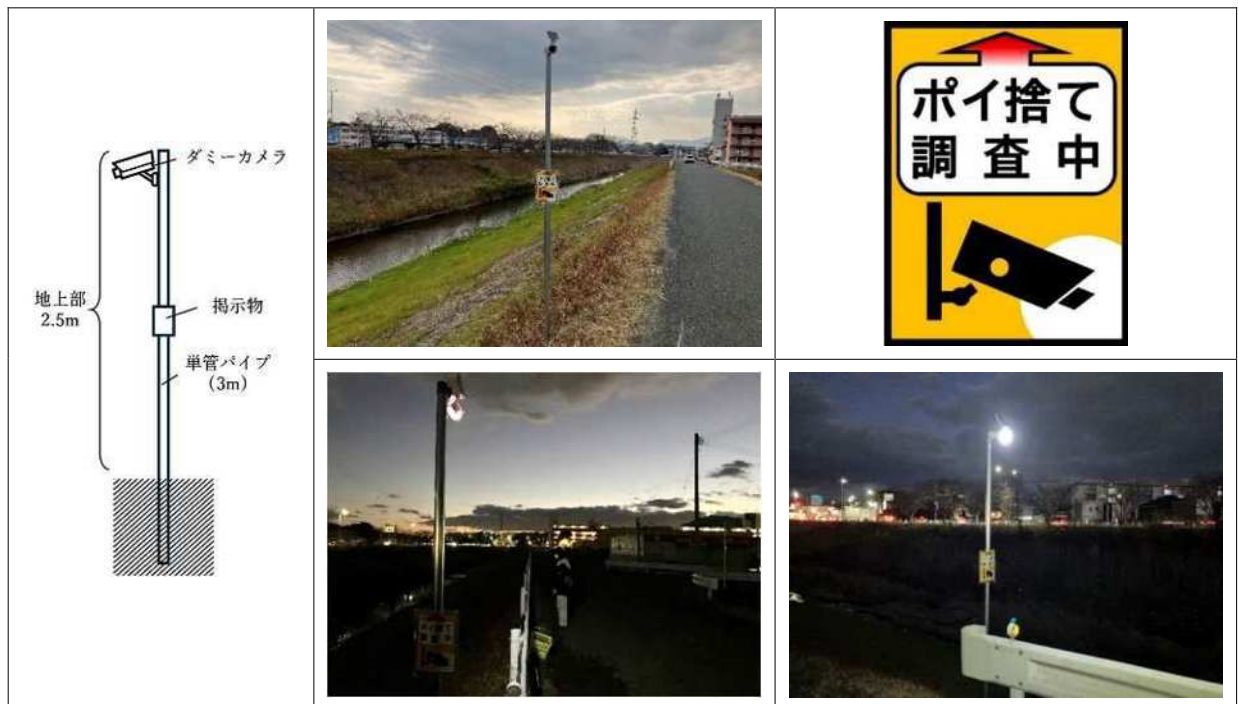
図7-1-9 ダミーカメラのデザインと実際に対策区間に設置したダミーカメラ
