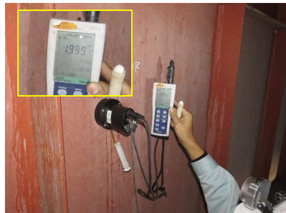
(b) 塩分量の計測 ( 1,999\text{mg}/\text{m}^2 以上付着)
