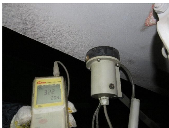
図解-10.7 ブラスト後の測定例 ( 322\text{ mg}/\text{m}^2 が残存)
