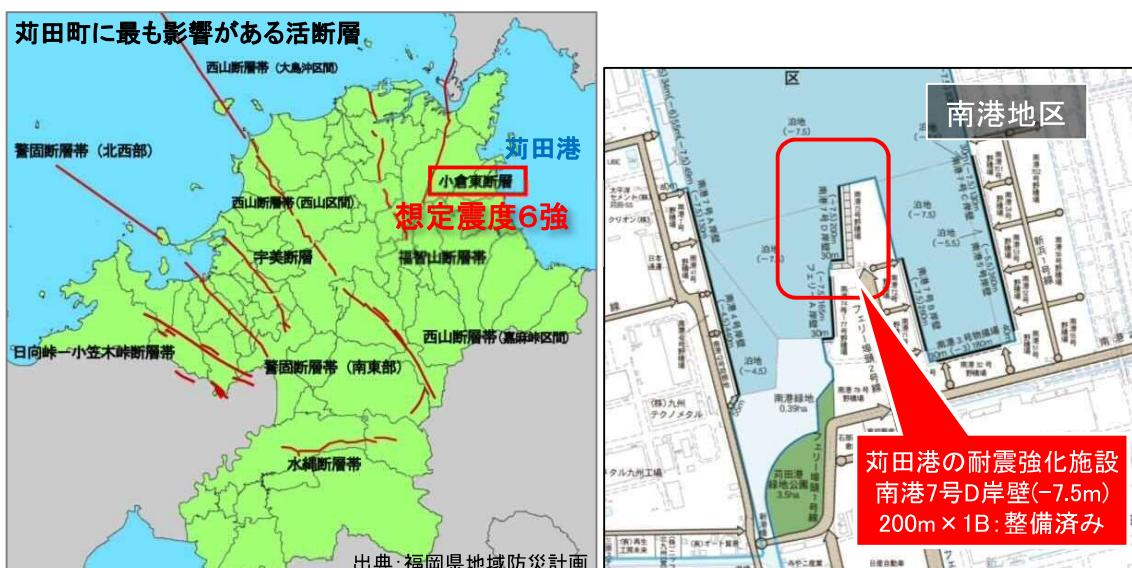
図 5.16 苅田港の想定地震（小倉東断層）と耐震強化岸壁
