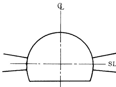
図-16 ロックボルト軸力計の測線配置
