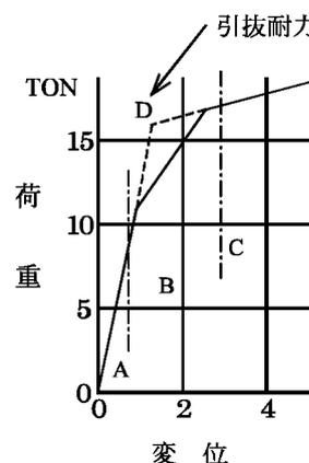
図-27 ロックボルト引抜試験
