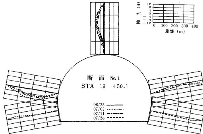
図-17 ロックボルト軸力分布図(例)
