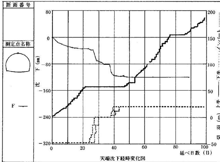
図-3 天端沈下経時変化図(例)
