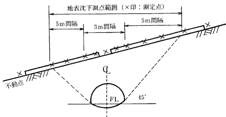
図-22 地表沈下測点の配置
