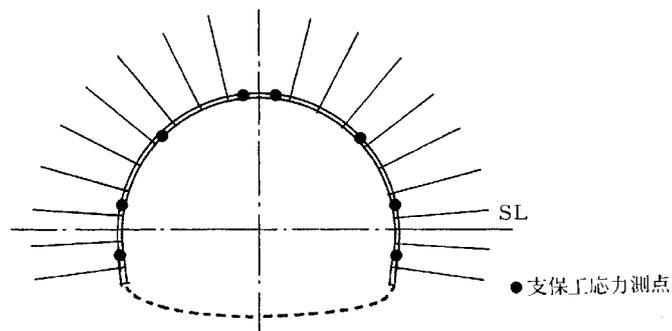
図-25 鋼製支保工測点配置図
