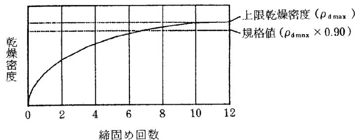
③ 上限乾燥密度を最大乾燥密度と定義し、その規格値 ( $D_c \geq 90\%$ ) で管理する。
