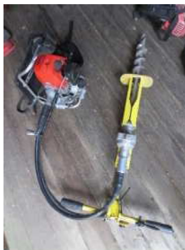
軽労化を目的として導入された植林用穴掘機
