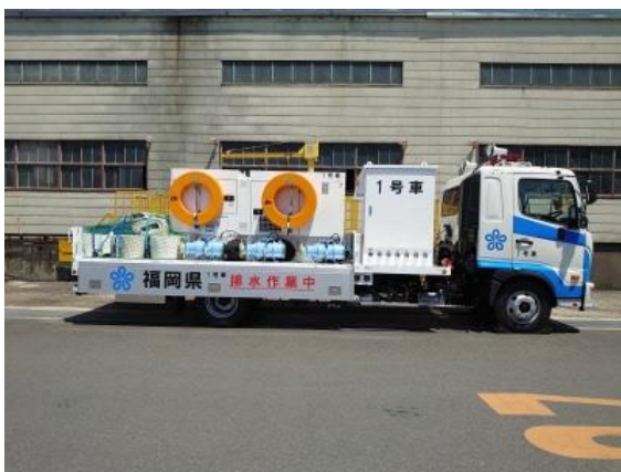
写真 4-20 排水ポンプ車(県)
