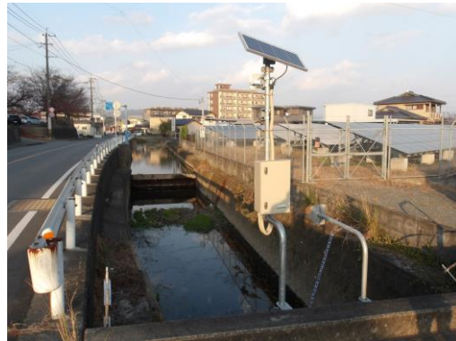
写真 4-22 簡易監視カメラの設置状況(八女市の例)
