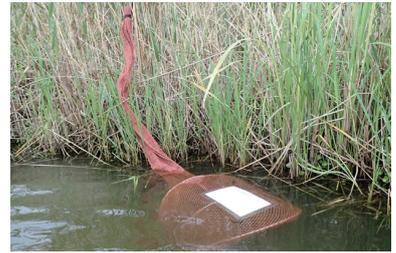
調査札を取り付けた後、完全に沈まないように設置する。空のペットボトルを入れて沈まないようにする方法もある
