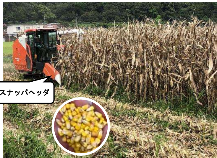
汎用型コンバインにスナツパヘッドを装着し収穫 丸内写真：収穫物
