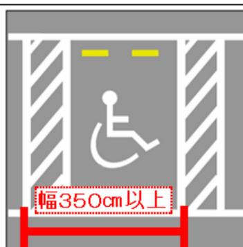
駐車スペースに350センチ以上の幅を確保することで、車の乗り降りや、その際に必要な車いすの方向転換を円滑に行うことができるようになります。
