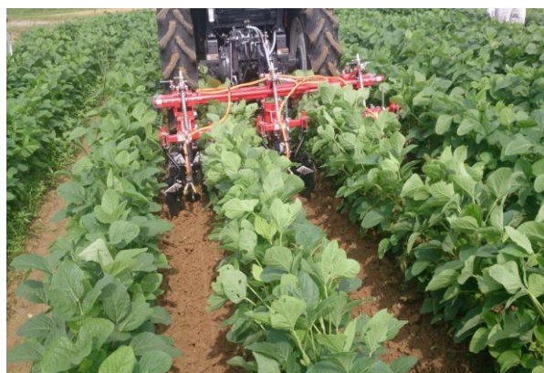
中耕ディスクに装着した除草機
