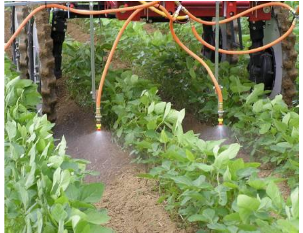
吊り下げノズル噴口の高さ
