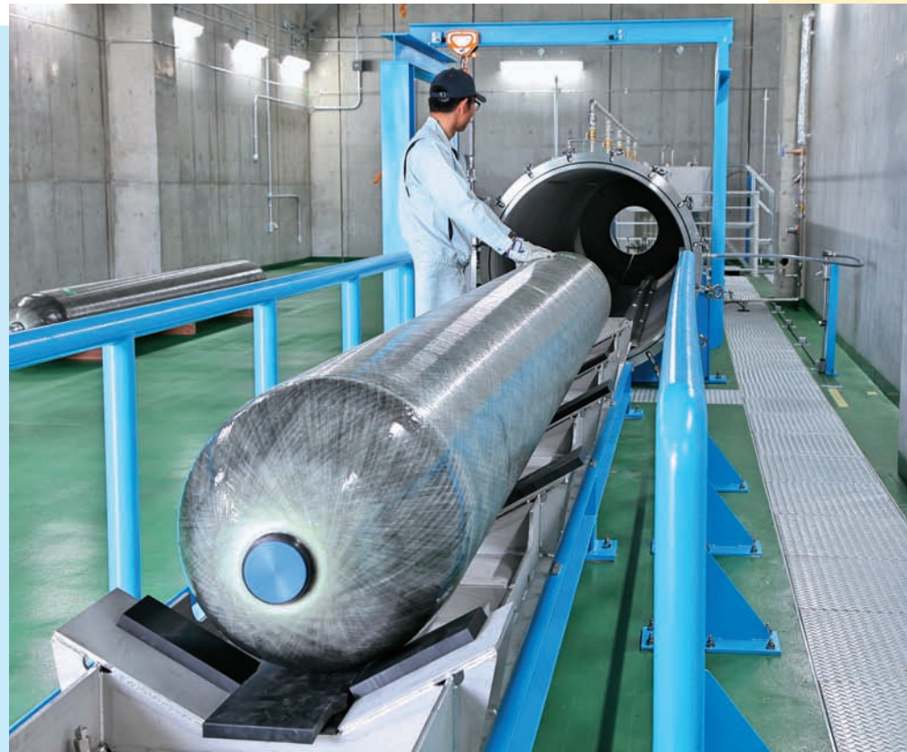
センサー、バルブなどの小型製品から、FCV用のタンク、水素ステーション用のタンク（長さ6m、直径80cm）などの大型製品まで、目的に応じた20の試験室を完備
