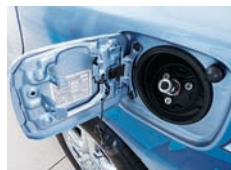
FCVの補給口はガソリン車に似ている。満タンになるまで約3分
