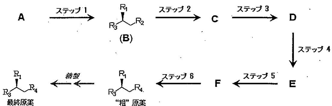
ステップ 5において中間体 F の生成後、混合物は加熱還流される。還流下、中間体 F の加水分解により不純物が生成する。
