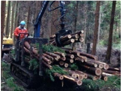
フォワーダ (積載式集材車両) による 木材の搬出状況
