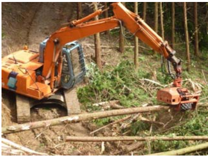
ハーベスタ (伐倒造材機) による 木材の生産状況
