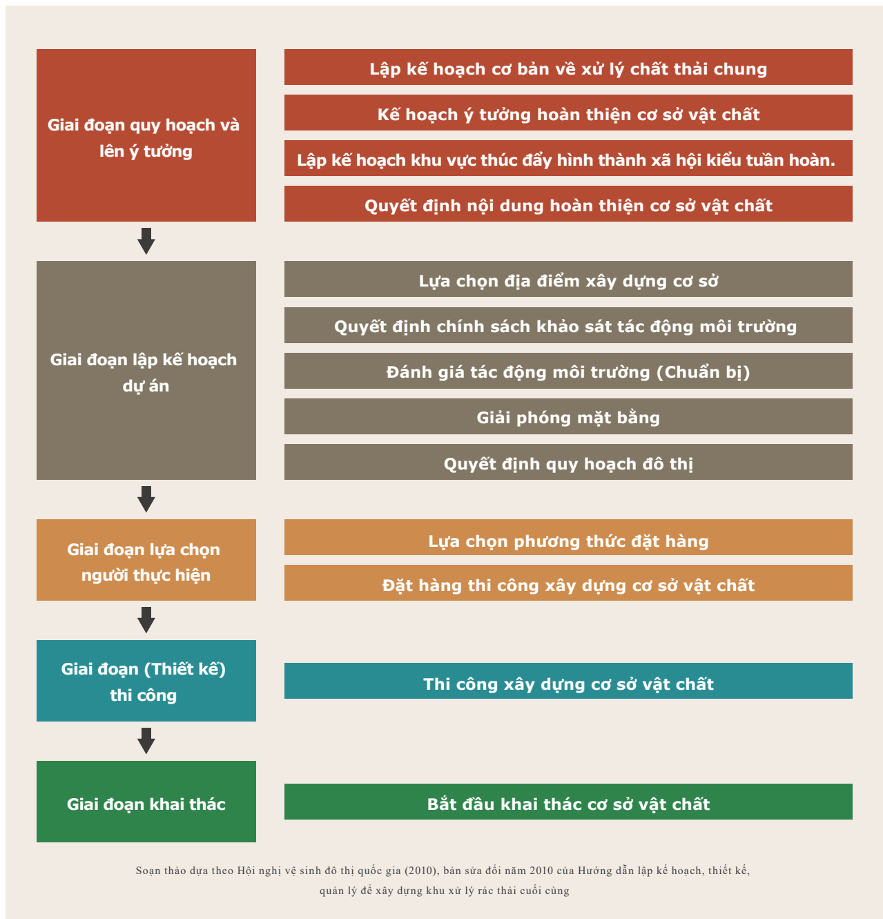
Hình 4: Các hạng mục và nội dung xây dựng khu xử lý chôn lấp rác thải cuối cùng tại Nhật Bản
