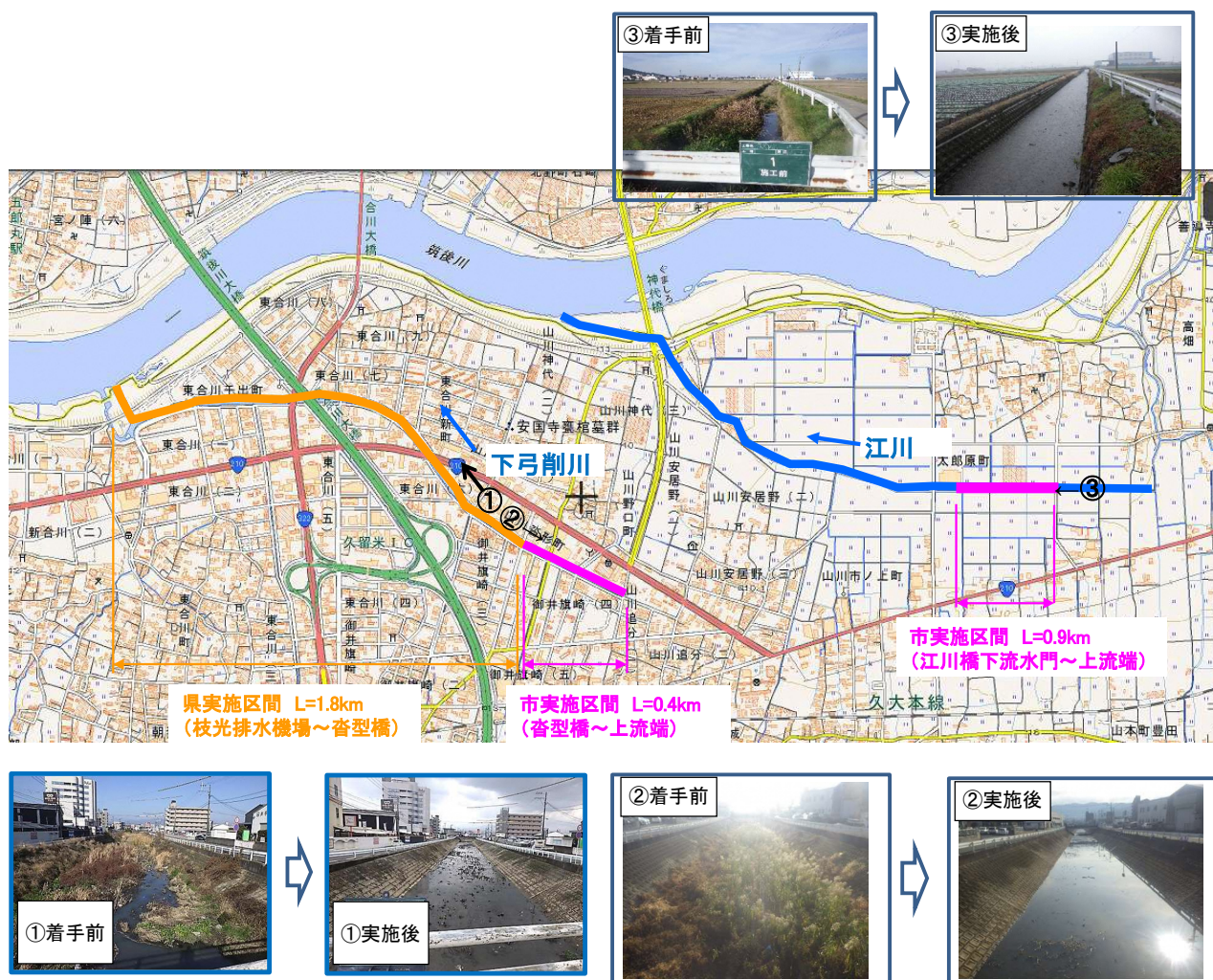
図 4-13 下弓削川・江川における河道内の土砂掘削等（H30年7月豪雨後対応）
